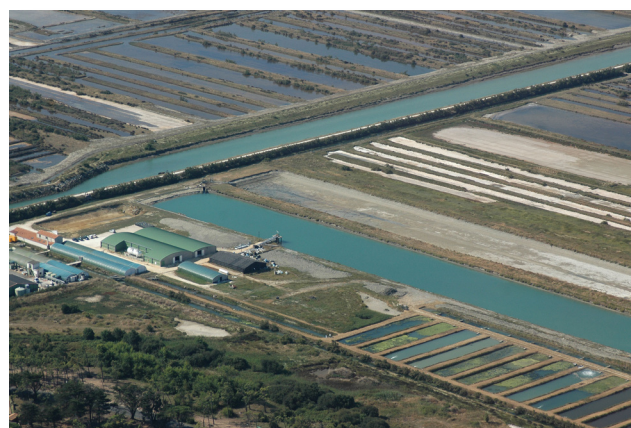
Un exemple de système intégré basé à terre à la Ferme Marine de Douhet (France), à droite en bas les 12 bassins de production de macroalgues utilisant les eaux de rejet de l'écloserie-nurserie de daurade royale (photo FMD)
